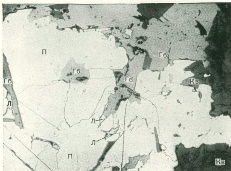
Фиг. 19. П — пирит; Кв — кварц; Гб — гюбнерит; Л — линдстремит. \times 46 . Шлиф полированный.
