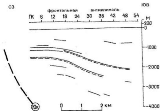
Рис. 17. Юкаликулевский надвиг на сейсмопрофиле 13<sup>а</sup>, предполагаемый на западном крыле фронтальной антиклинали в районе верхнего течения р. Сунга
