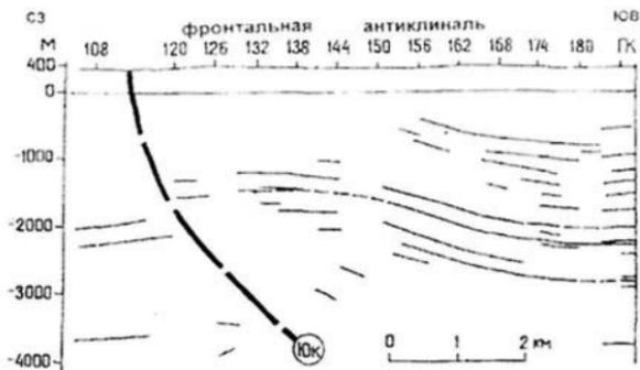
**Рис. 14.** Юкаликулевский надвиг на сейсмопрофиле 11, выделенный между пикетами 108 и 120
