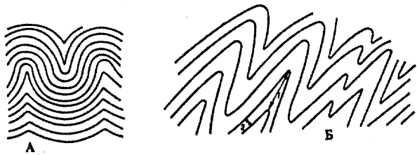
Рис. 5.1. Складки (А) концентрические и (Б) подобные (по В.В. Белоусову)
