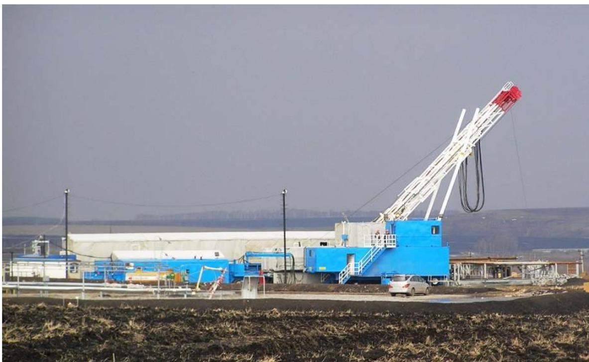
Рис.20.13 Буровой станок DRECO 2000M для наклонного бурения.
