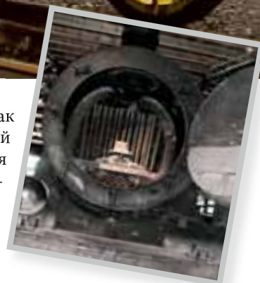
ДЫМОГАРНЫЕ ТРУБКИ В КОТЛЕ ПАРОВОЗА
