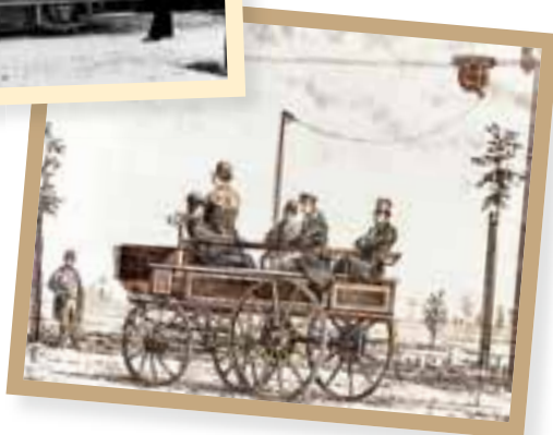
Первый в мире троллейбус Electromote конструкции Вернера Сименса, Берлин, Курфюрстендамм, 1882 г.
