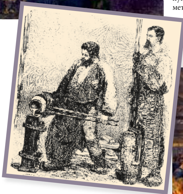
Рабочий выливает тигельную сталь в изложницу
