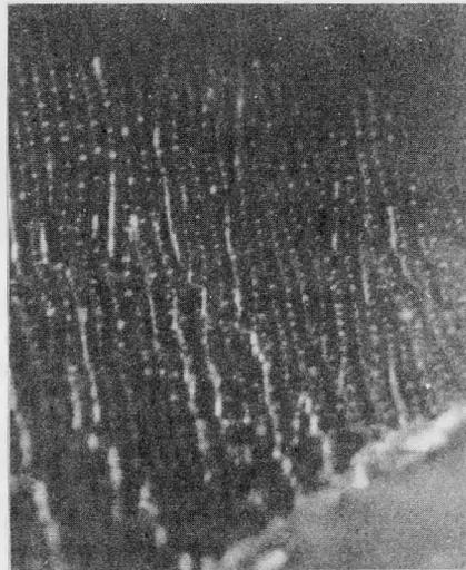
Рис. 5. Структурно-морфологическая пористость под двухгранным рельефом деконтированной поверхности фронта кристаллизации
