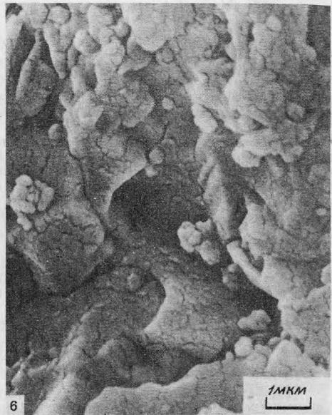
Рис. 5. Глобулярная структура хризопраза в сканирующем электронном микроскопе, Шкляри, ПНР (обр. 74805); травление HF, напыление углем и серебром
