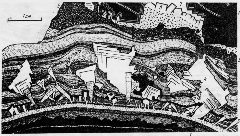
Рис. 1. Строение флюорит-баритового отстойника (гравитационная текстура одновременного роста) на поверхности флюоритовой кокарды, месторождение Усуглинское
