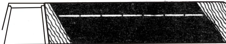
Рис. 8.4. Расположение секционной борзды на стенке орта, пересекающего мощной рудное тело
