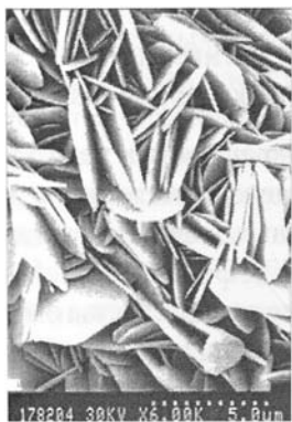
Рис. 3.6. Упорядоченное распределение пластинчатых чешуек хлорита в цементе песчанника свидетельствует об аутигенном генезисе этого минерала (на одной из постседиментационных стадий). Фотографии скола в растровом электронном микроскопе
