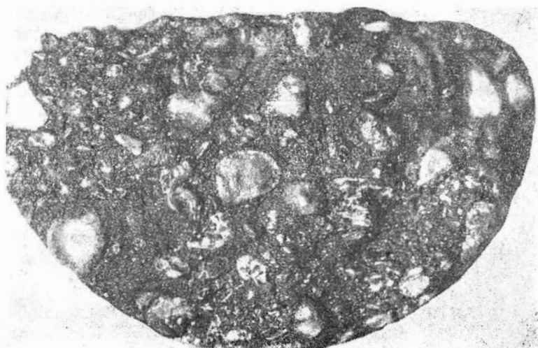
Рис. 24. Галенки и гравий гизингерита в руде с лептохлорито-гизингеритовым цементом. Края некоторых галек осветлены за счет выщелачивания железа и упрочнены за счет раскристаллизации и кремнивого гелия. Обр. 371, скв. 39, Бакчарское месторождение, нат. вел.
