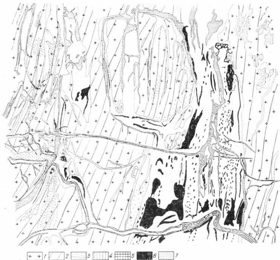
Рис. 15. Типичный пример внутреннего строения штокерково-вкрапленной зоны минерализации (месторождение Кварцитовая сопка, гор. 170 м).
