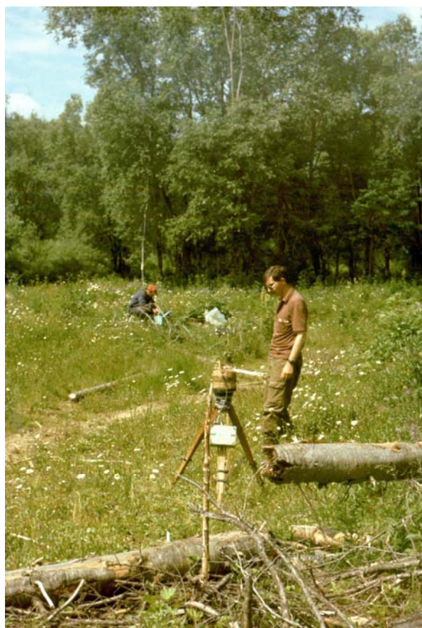
Низкочастотная индуктивная электроразведка с аппаратурой ВТИМП-1 в 1991 г. на золото-магнетитовом месторождении Горного Алтая: на заднем плане оператор С.З.Овешников, на переднем плане - студент из Германии Кинаст Хаген
