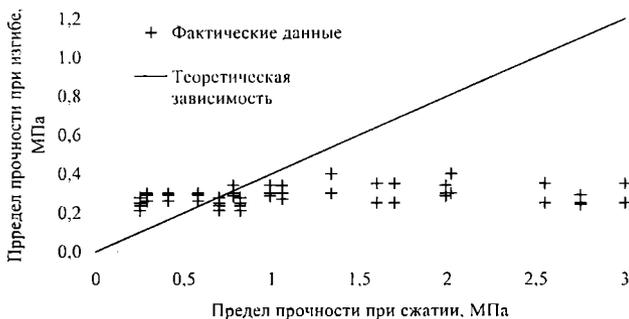
Рис. 2.1.4. Фактические данные измерений предела прочности льда при изгибе, по результатам испытания клавиш, и предела прочности нижнего слоя ледяного покрова при сжатии, в сопоставлении с теоретической зависимостью из (СНиП 2.06.04-82, 1996) (Печорское море, апрель 1996 г.)
