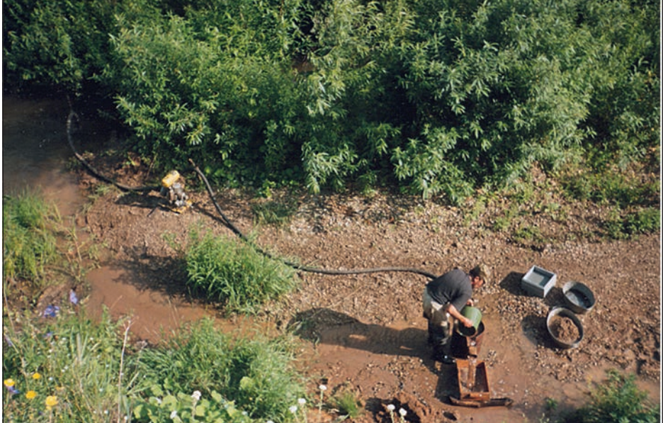
Для извлечения микрофоссилий из рыхлых пород в полевых условиях можно провести отбор вручную (с помощью сит 0,5-1 мм) или специальных машин для промывки. Фото Г.А. Данукаловой.
