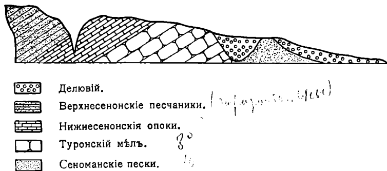
Рис. 9. Наклонъ верхнемѣловыхъ слоевъ въ оврагѣ у с. Б. Князеви.
