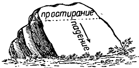
Фиг. 6. Определение положения в пространстве наклонных пластов при помощи двух линий. Из Штутцера (Geologisches Kartieren und Prospektieren, 1924).
