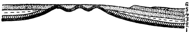
Фиг. 34. Схематический профиль Полесского (Скифского) вала. 1 — кембрий; 2 — нижний силур; 3 — верхний силур; 4 — девон; 5 — карбон; 6 — юра.
