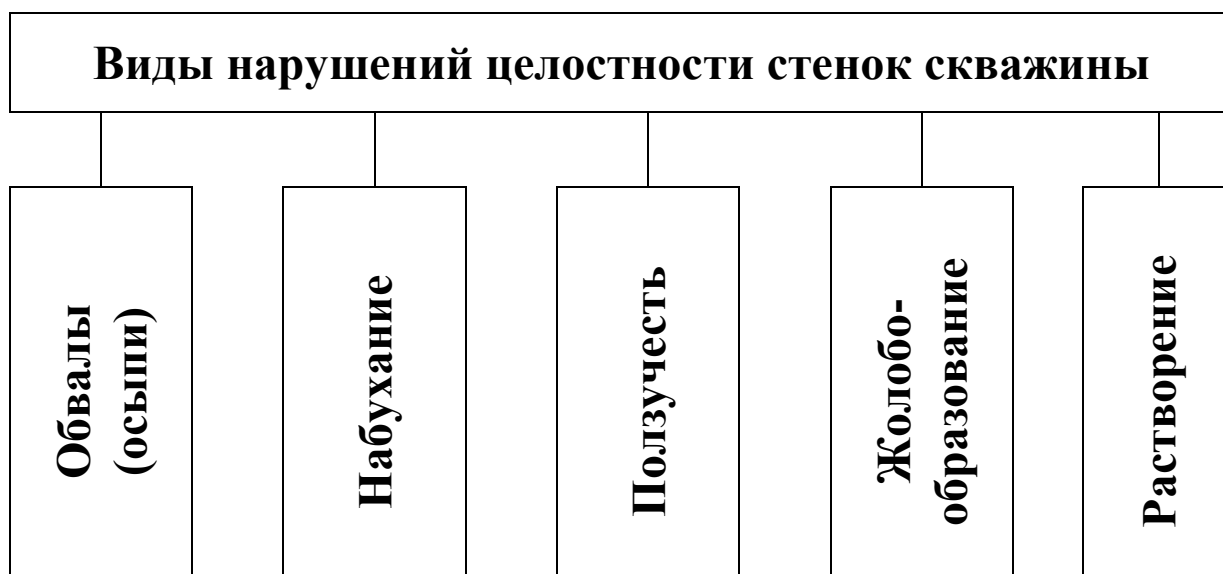
Рис. 5.1. Классификация нарушений целостности скважины (по Ю. В. Вадецкому)
