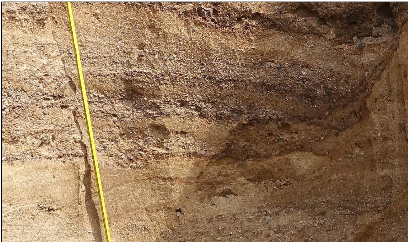
Рис. 3. Вертикальные трещины во флювиогляциальных отложениях московского горизонта. (Фото В.А. Зайцева)
