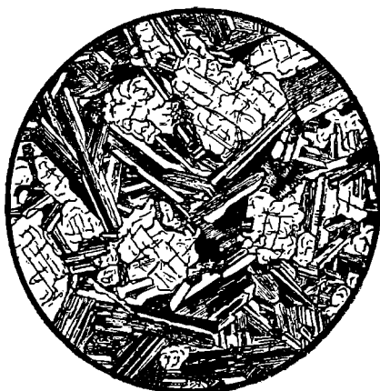
52. Internal structure of a diabase, magnified. After A. Osann. Courtesy of Die Schweizerbartsche Verlagsbuchhandlung, Stuttgart.
