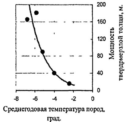
**Рис. 2.** Зависимость мощности твердомерзлой толщи Западного Ямала от среднегодовой температуры пород. Построено с использованием данных (Баду, Харькозов, 1987, Дубровин, 2003, Кондаков и др., 2001).
