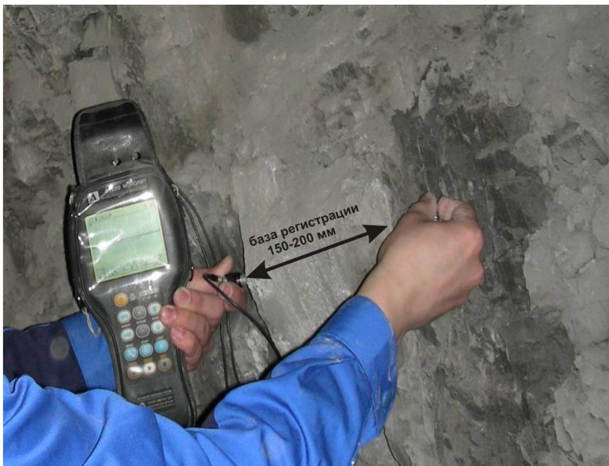
Рис.3.8. Ультразвуковые измерения на обнажении забоя тоннеля
