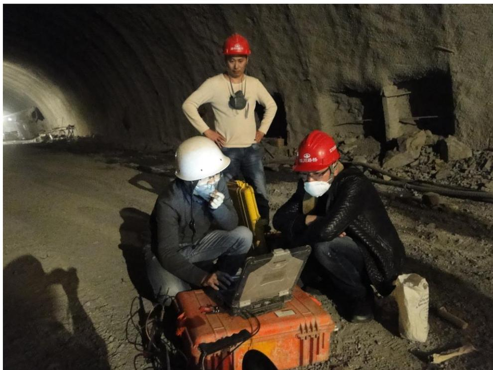
Рис. 4.16. Работа с системой TRT 6000 в тоннеле Гулин (КНР).
