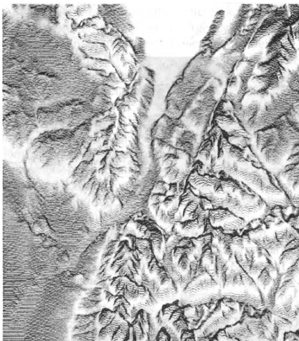
Рис. 3.18. Объемная модель рельефа SRTM района горного сооружения Саян (по Д. Г. Загубному). Четко проявлены разломы, нарушающие рельеф горного обрамления впадины (светлый однородный тон)
