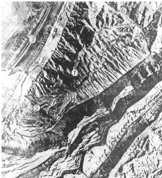
Рис. 4.7. Антиклинальная складка, проявленная структурно-денудационными формами рельефа. АФС. 1-4 — элементы складки:
