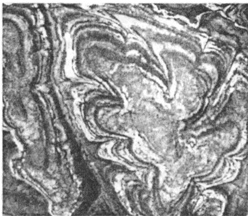
Рис. 4.3. Горизонтальное залегание осадочных отложений. Восточная Сибирь. АФС. Переслаивание плотных (темных) и менее плотных (светлых) песчаников, к которым избирательно приурочена растительность, создает полосчатый рисунок изображения, похожий на горизонтали рельефа на топографических картах
