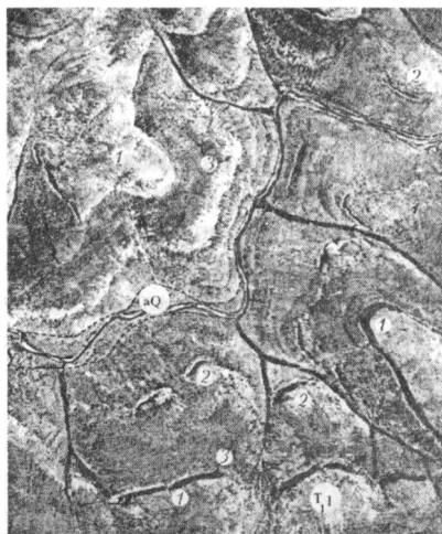
Рис. 4.21. Лавовая свита нижнего триаса. Сибирская платформа. АФС. Выходы крепких эффузивов образуют структурную поверхность (1) и структурные ступени (2) на склонах водоразделов. Их крутые и обрывистые уступы (3) выражены светлыми и темными полосами в зависимости от освещения во время съемки
