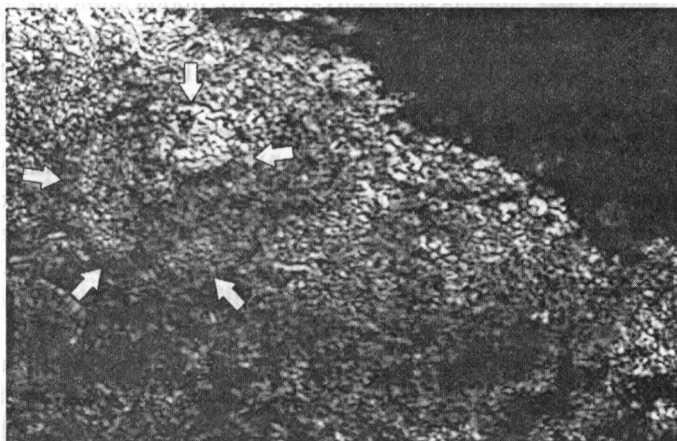
Рис. 10.32. Анализ отношения каналов космического снимка JERS-1 (деление 3-го канала на 1-й канал). Тимано-Печорская нефтегазоносная провинция (по И. О Смирновой и др.)
