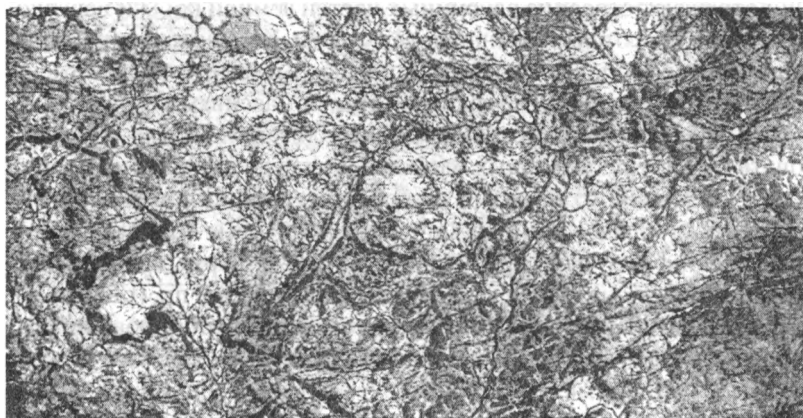
Рис. 8.10. Космический снимок Landsat среднего пространственного разрешения района Балтийского щита. Гранитоиднейсы интенсивно нарушены разрывами. Темным тоном выделяются дайки габбро-амфиболитов
