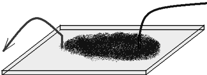
Рис. 1. Схема моделирования гидротоков в щелевой камере
