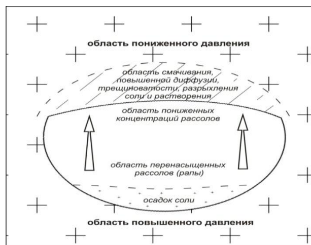
Рис. Схема "Рассольного пузыря" в соленосной толще, процессов и сил, обуславливающих его передвижение. Стрелками указано направление воздействия избыточного давления и перемещения "пузыря"
