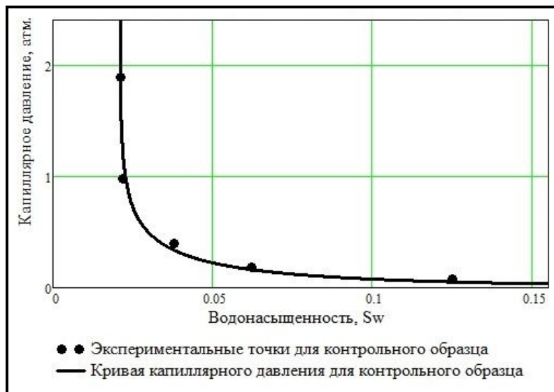
Рис. 3.4. Зависимость капиллярного давления от водонасыщенности для контрольного образца
