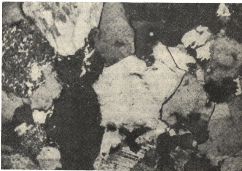
Рис. 11. Кварцитовидная структура олигомиктового песчаника нижней перми (обр. № 58/47 \times 200).
