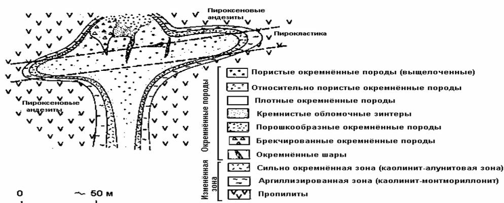
Рис. 8.5.2 Схематический разрез распределения гидротермальных изменений, окремнения и рудообразования в месторождении Нансатсу.
