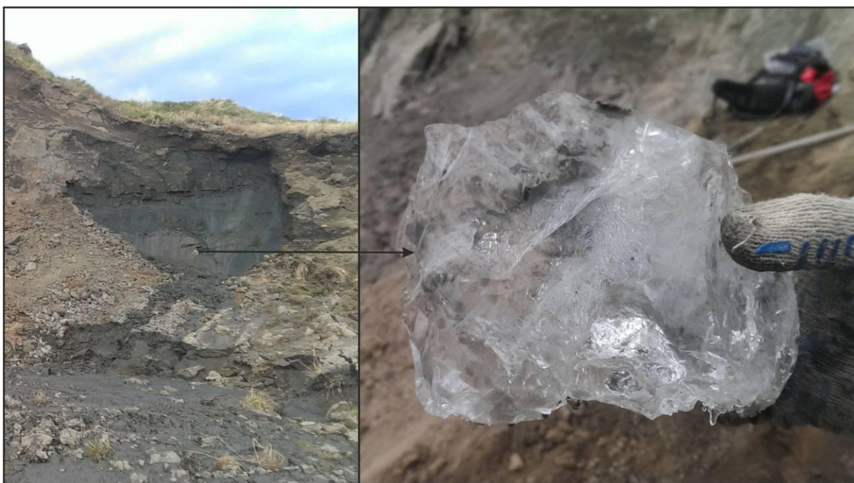
Рис. 2.7. Внешний вид стекловидного льда из залежи пластового льда.
