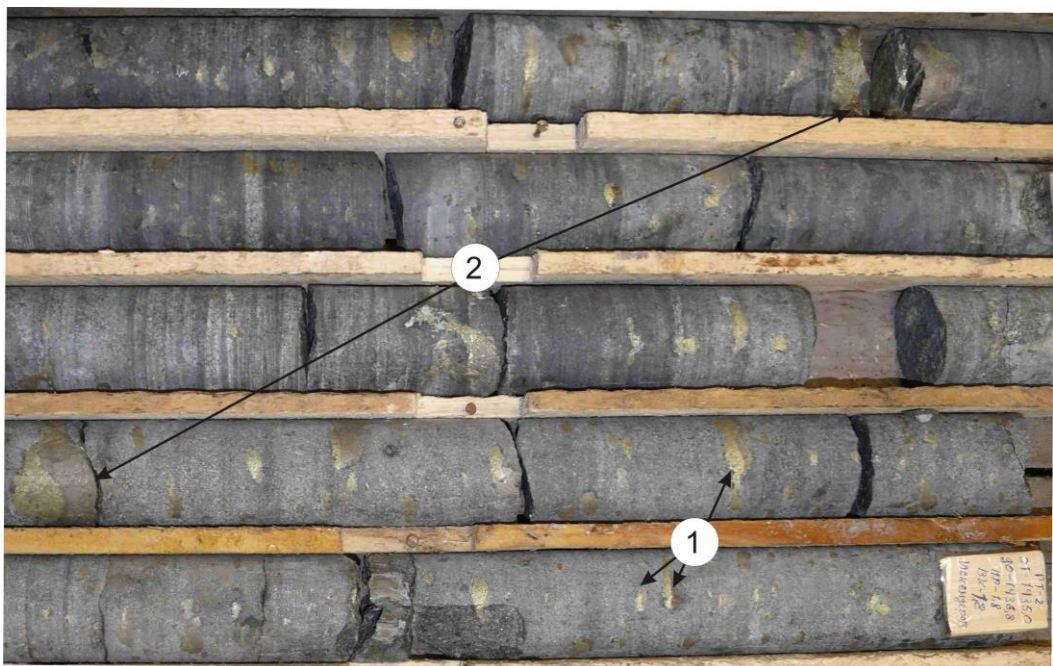
Рис. 2.3. Пикритовый габбродолерит, отчетливо видна типичная для норильских рудоносных интрузий уплощенная, каплевидная, расслоенная вкрапленность халькопирит-пирротинового состава (1) и два шлира (2) размером более 5 см. Хараелахский интрузив скв. PT-2.
