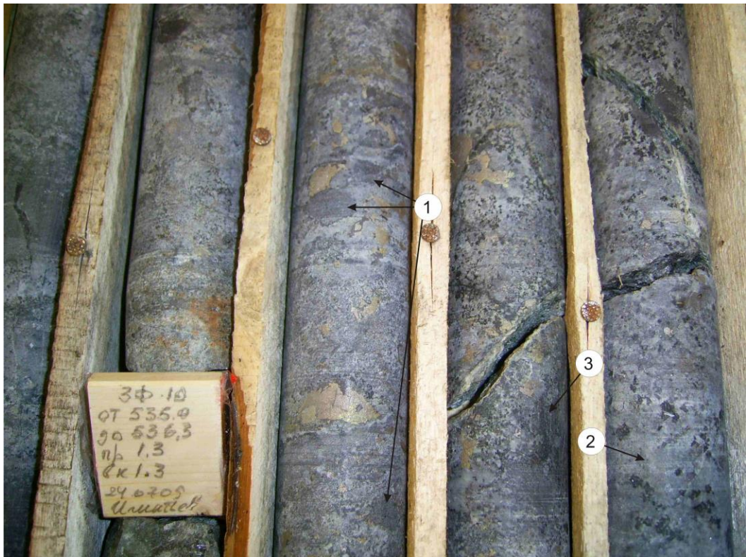
Рис. 2.2. Такситовый габбродолерит, отчетливо видны обломки с острыми углами (1), лейкократовые (2) и меланократовые (3) участки с различной степенью раскристаллизации и типичная для такситов ксеноморфная расслоенная вкрапленность халькопирит-пирротинового состава. Хараелахский интрузив скв. 3Ф-10.
