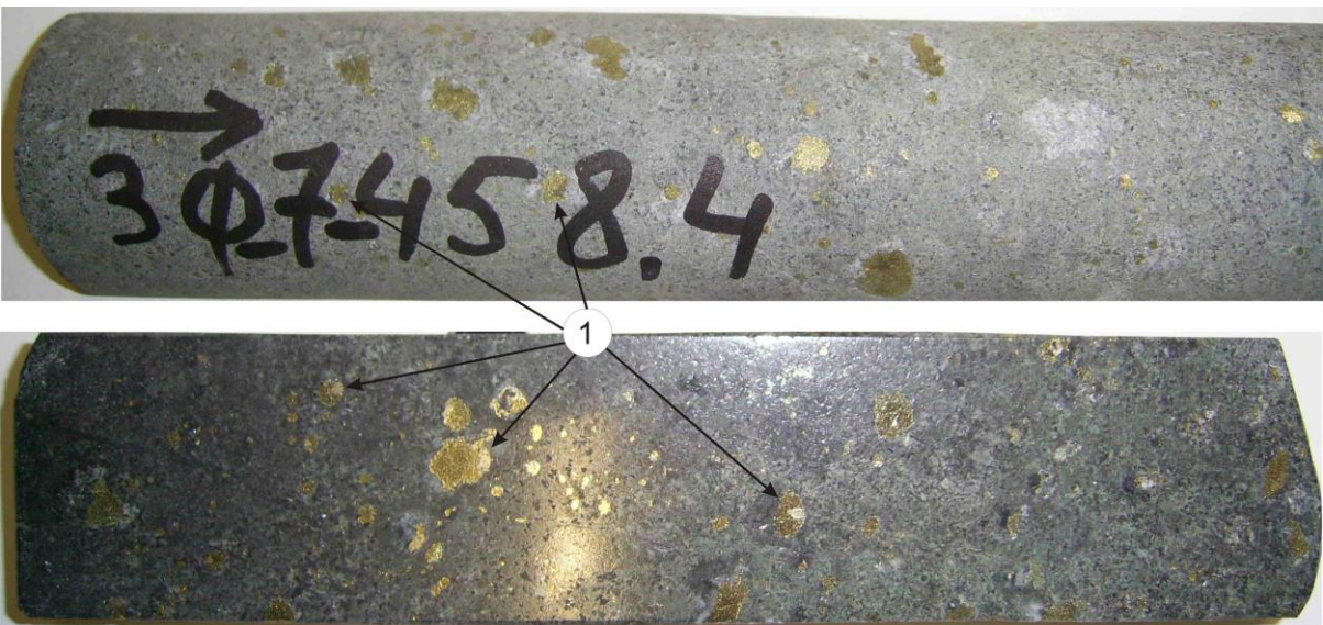
Рис. 2.8. Контактный габбродолерит, отчетливо видна изометричная, пересыщенная халькопиритом вкрапленность, характерная для фронтальной фации интрузивов. Причем пирротин утонул в халькопиритовом расплаве, образуя соотношения «шарик в шарике». Хараелахский интрузив скв. ЗФ-7.
