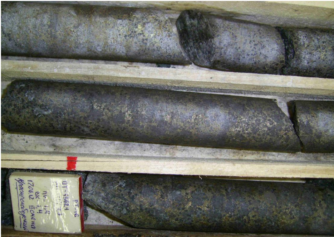
Рис. 2.4. Сидеронитовый габбродолерит, отчетливо видна типичная для этой разновидности массивная текстура и богатая интерстиционная вкрапленность халькопирит-пирротинового состава. Хараелахский интрузив скв. РТ-16.
