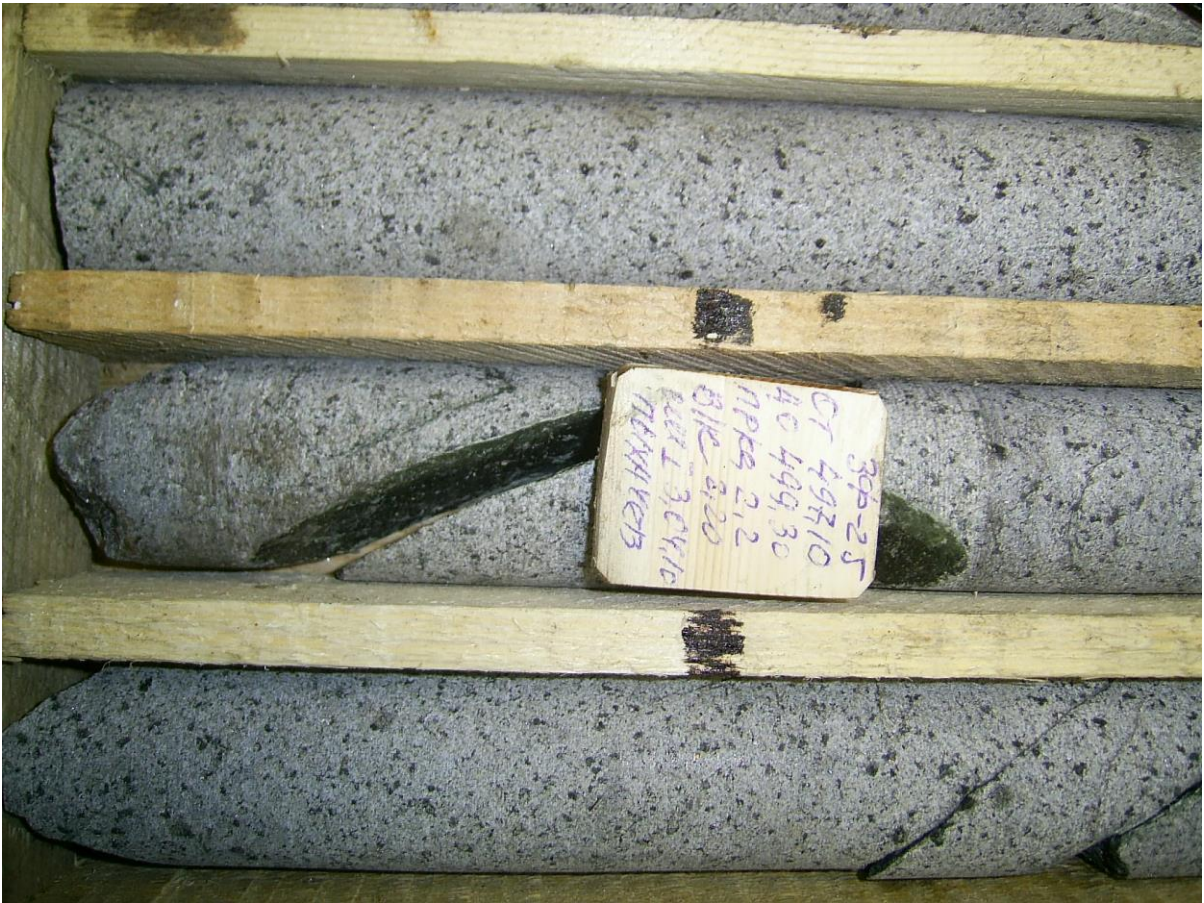
Рис. 2.7. Габбродолерит оливинсодержащий, для этих пород, составляющих более 50 % от мощности рудоносных интрузий, характерна массивная текстура, мелкозернистая габбродолеритовая структура. Хараелахский интрузив скв. ЗФ-25.
