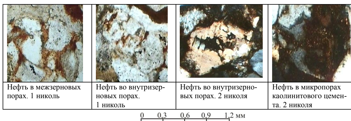
Рис. 4. Распределение нефти в поровом пространстве песчаников горизонта Ю 1 Малореченского месторождения
