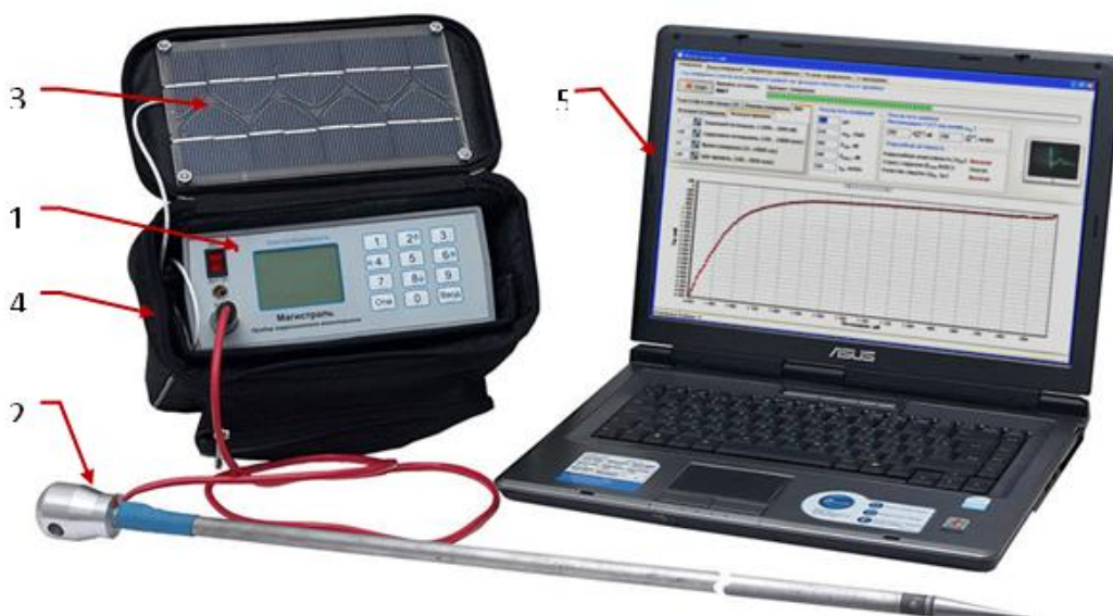
Рис. 3. Комплекс для диагностики и оптимизации электрохимзащиты стальных подземных сооружений «Магистраль-1»
