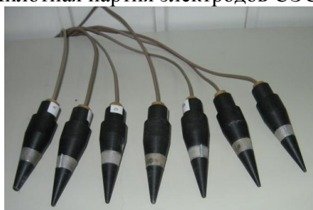
Рис. 3. Пилотная партия сухих безэлектролитных электродов сравнения
