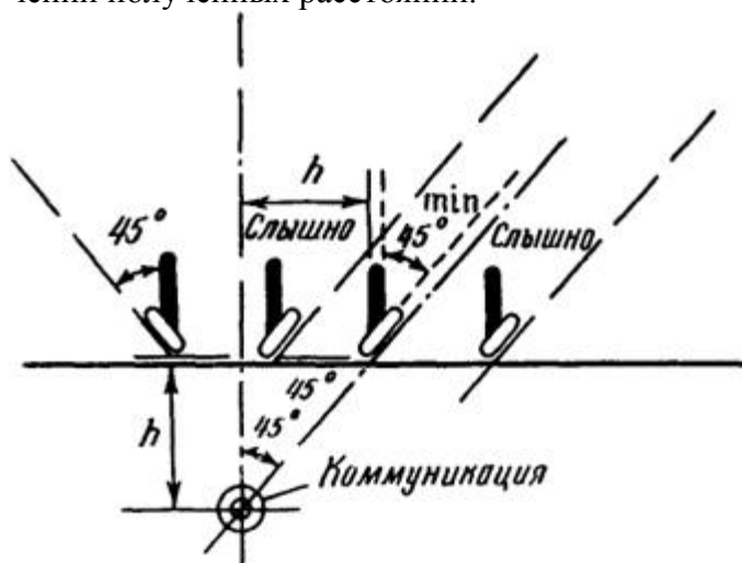
Рис. 2. Схема определения высотного местоположения подземной коммуникации при помощи прибора поиска
