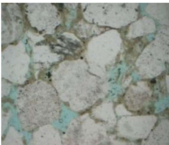
а) № 60042, пласт B_{12}^2 , 1 ник, увел. 126. Пленочный хлорит-гидрослюдистый цемент.
