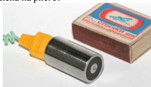
Рис. 3. Пилотная партия сухих безэлектролитных электродов сравнения
