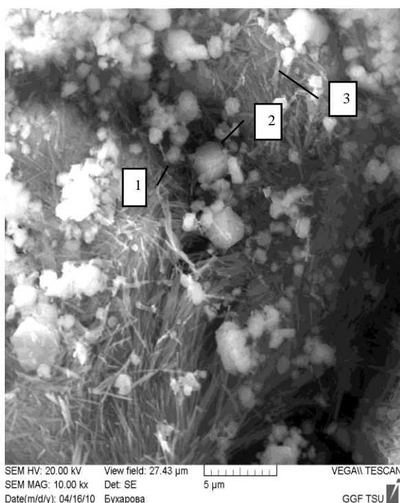
Рис. 3. Агрегат глинистых минералов, включающий в себя 3 минеральные фазы: 1 – каолинит, 2 – иллит и 3 – диккит. Фото РЭМ. Образец № 165
