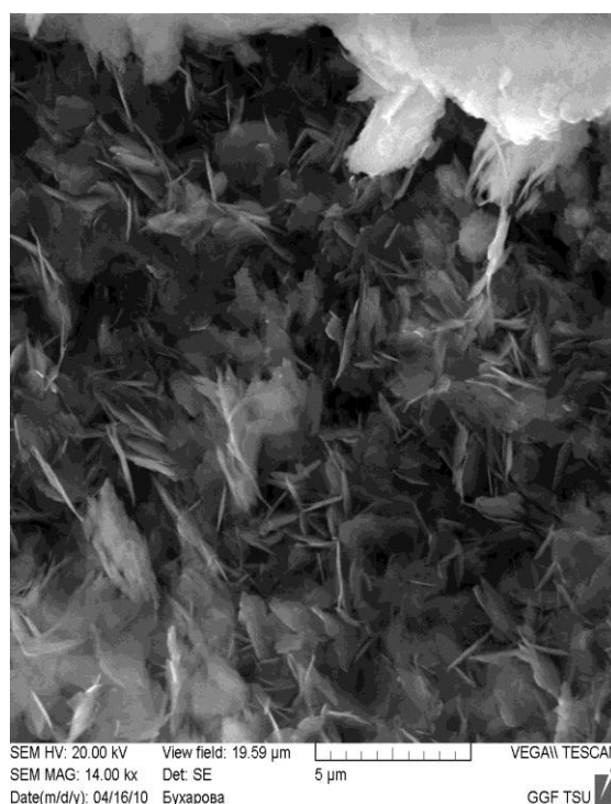
Рис. 4. Кристаллы иллита. Фото РЭМ. Образец №161
