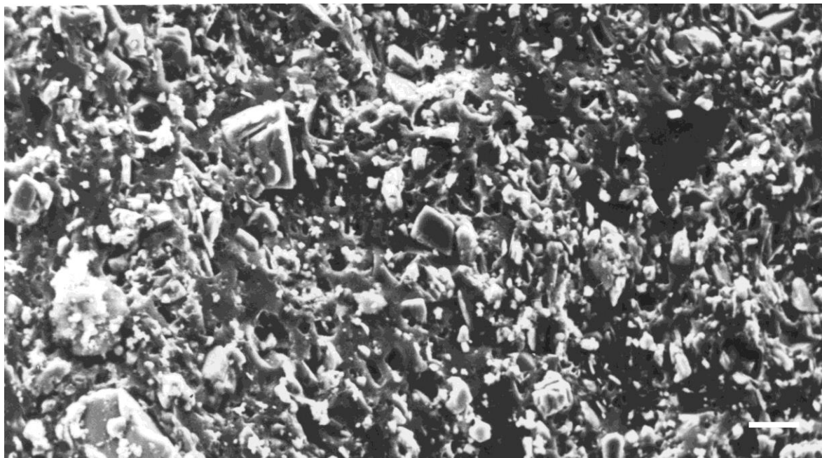
Рис. 22. Микроструктура шунгита, м-ние Шуньга. Растровый электронный микроскоп SEM-501B (Philips), детектор отраженных электронов. Масштабная линейка равна 10 мкм. Светлое – минеральные включения, серое – ШВ, черное – поры (фото А.Р. Нестерова)
