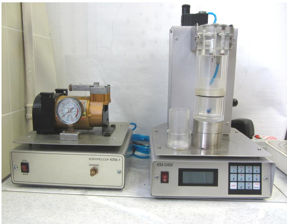
Рис. Карбонатомер КМ-04М
