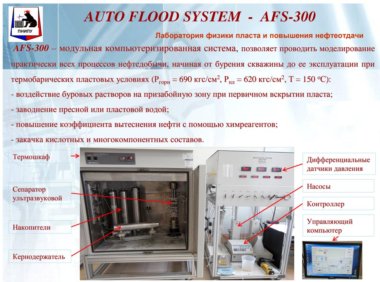
Рис. 11.1. Автоматическая система заводнения AFS-300
