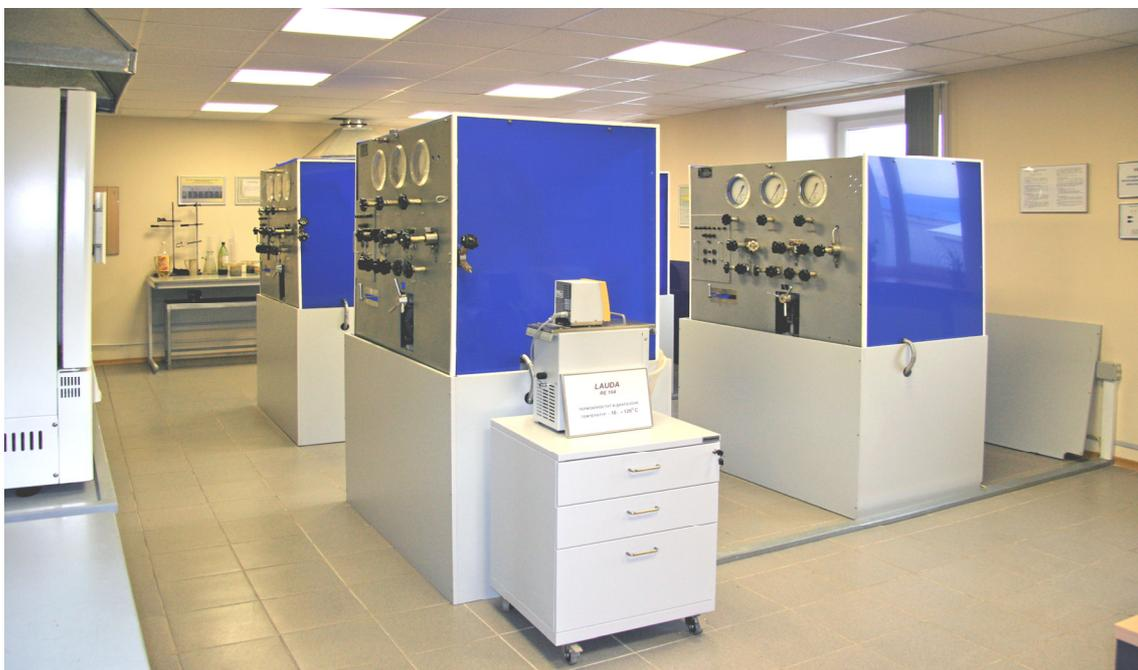
Рис. 11.2. Установки исследования проницаемости керна (УИПК)
