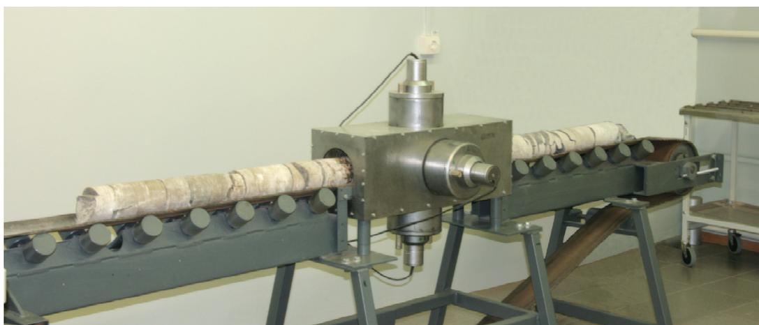
Рис. 2.7. Гамма-спектрометр «Спутник-Гео» для профильной гамма-спектрометрии керн
