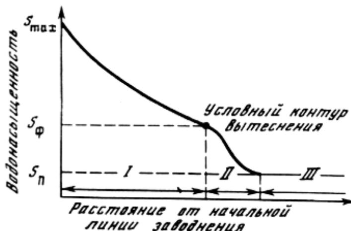
Рис. 10.2. Изменение нефтеводонасыщенности по длине пласта при вытеснении нефти водой
