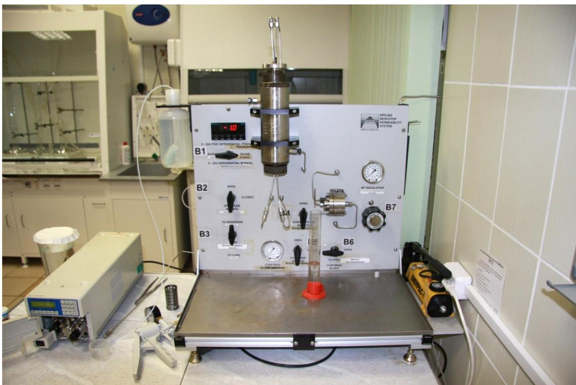
Рис. 11.3. Настольная система для определения проницаемости пород BPS-805
