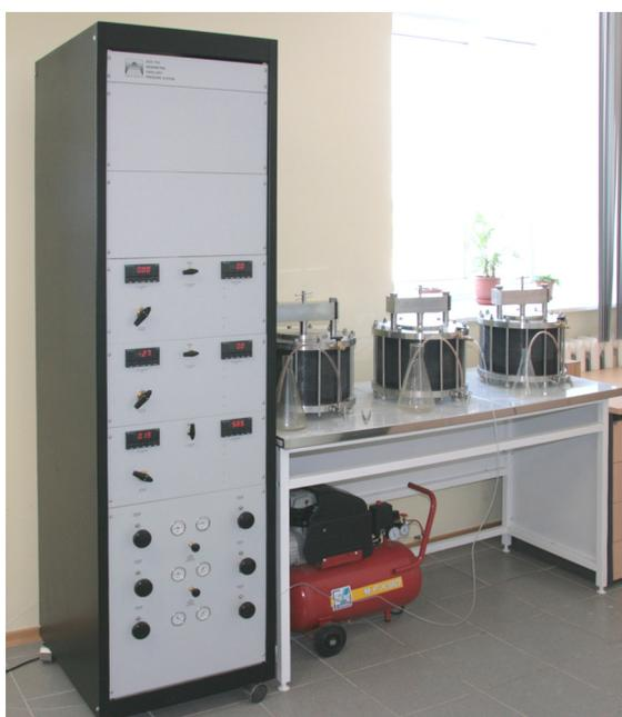
Рис. 1. Капилляриметры и блок подачи и контроля давления газа
