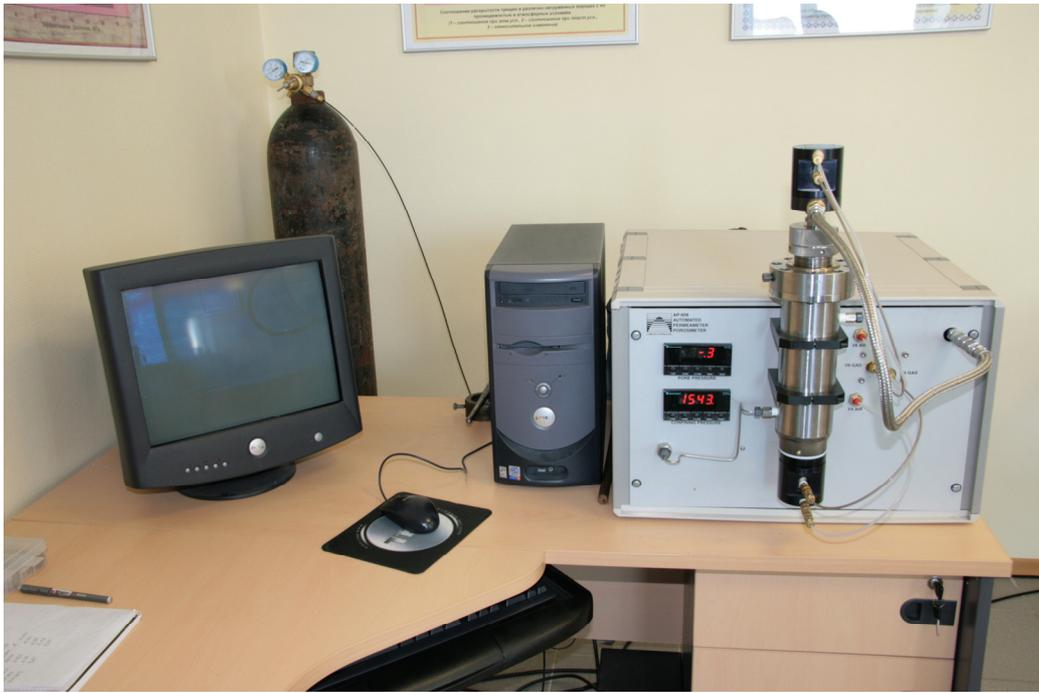
Рис. 1. Измеритель пористости и проницаемости по газу при атмосферных и пластовых условиях (AP-608) на цилиндрах диаметром 25,4 и 30,0 мм
