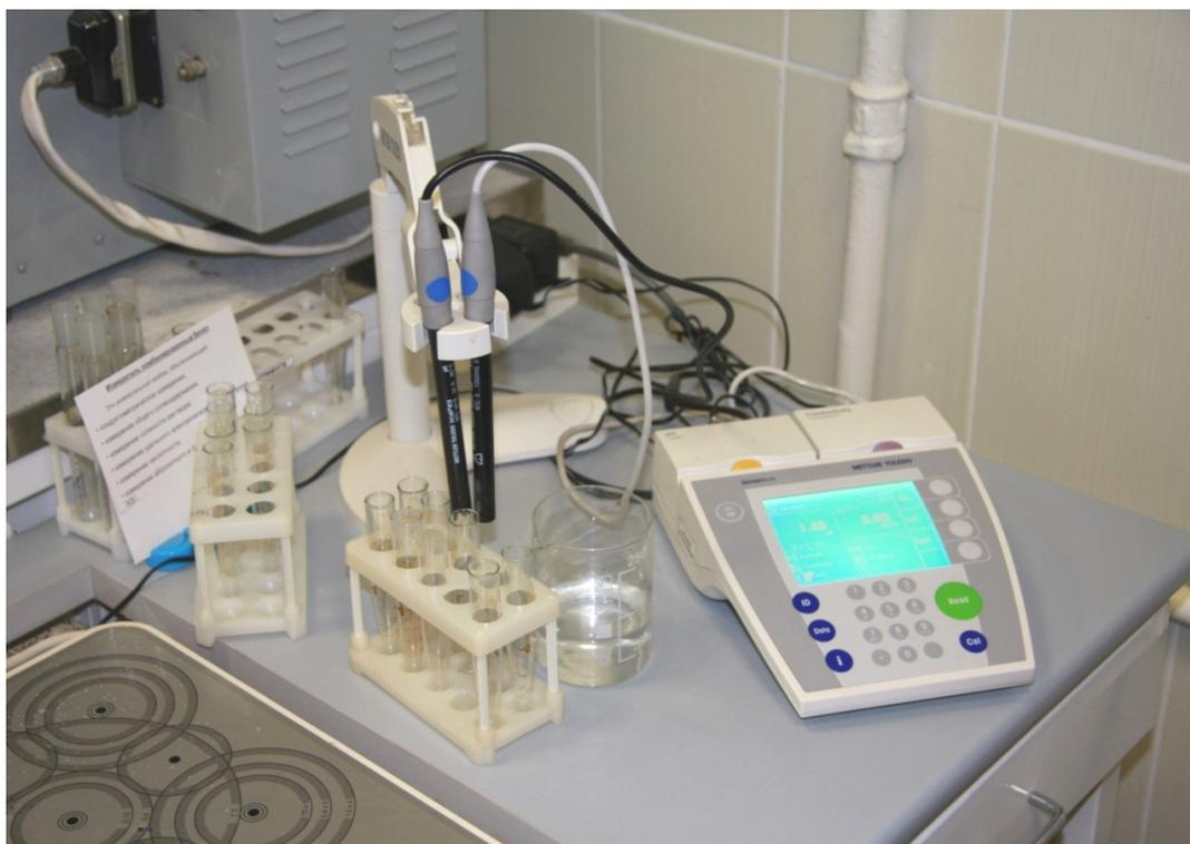
Рис. Описание прибора SEVEN MULTI
