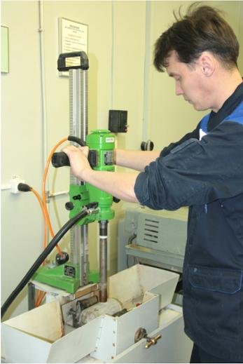
Рис. 2.11. Вертикально-сверлильный станок
