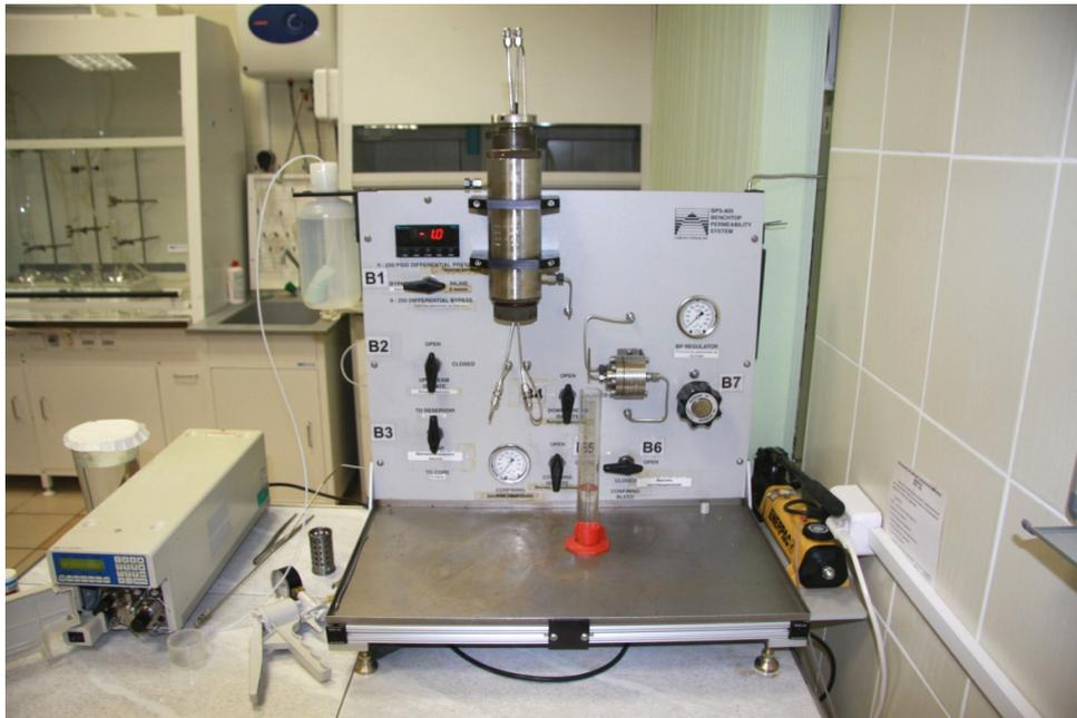
Рис. Настольная система для определения проницаемости пород BPS-805
