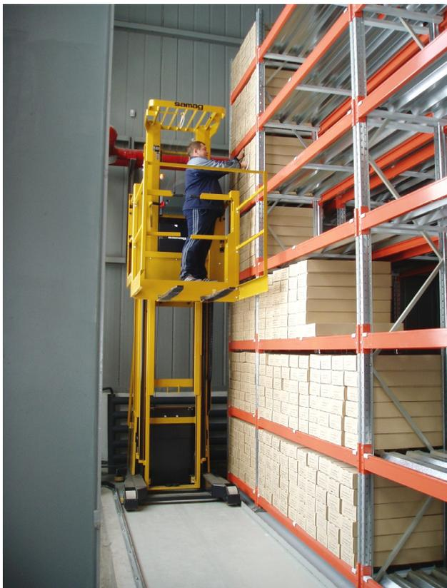
Рис. 2.9. Вилочный штабелер 4500 Samag (Италия), доставка, укладка и выемка керна из ячеек стеллажей
