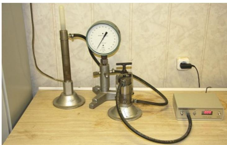
Рис. 2. Установка для измерения газопрооницаемости
