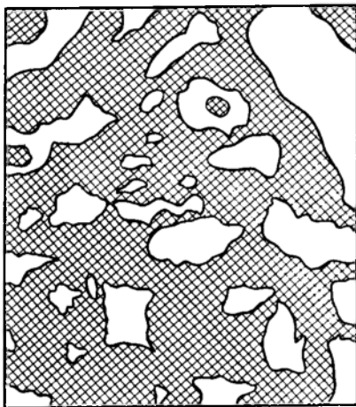
Рис. 12. Микрофотография радиограммы шлифа актинолита, обработанного раствором хлористого кальция (340 мг/л) \times 30 . Белые пятна — реагент (по С. И. Полькину, С. Ф. Кузькину, В. М. Голову)
