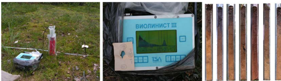
Рисунок 4.61. Полевой гамма спектрометр Violinist III и керны, отобранные на профиле Д-13
