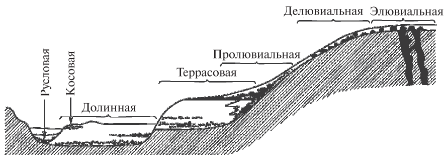
Рис. 16. Схема размещения россыпных месторождений различных классов и подклассов в поперечном сечении речной долины (по В. И. Смирнову)
