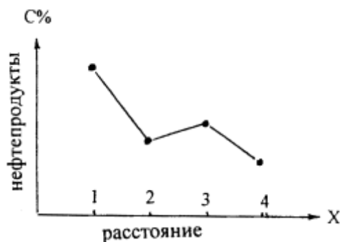
Рис.1.4. Иллюстрация линейной интерпретации результатов измерений. 1,2,3,4 – точки наблюдения.
