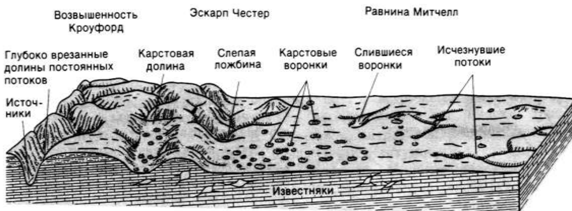
Рис. 8.21. Схематическая блок-диаграмма части карстового района на юге шт. Индиан [Аллисон, Палмер, 1984].
