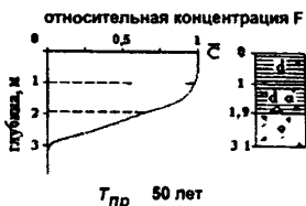
Рис. 4.15. Расчет предельно-допустимого времени эксплуатации золошлакоотвала Артемовской котельной
