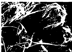
Рис. 2.12. Фотография с РЭМ (увеличение \times 600 ) высокоглино- земных образований аллофан- гипбситового состава:
