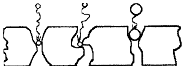
Рис. 1.17. Варианты глубинного удержания молекул в порах (Purchas, 1984)
