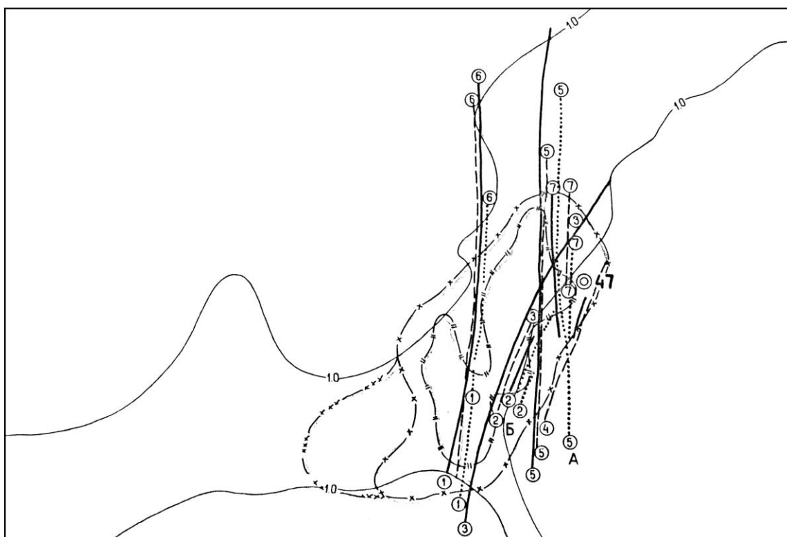
Рис. 67. Схема разломной тектоники на объекте «Вега» в Сеитовской (Утигенской) соляной структуре по данным ГПП «Спецгеофизика» (1992 г.). Линиями с цифрами выделены разломы и тектонические нарушения в пределах контура газохранилища.
