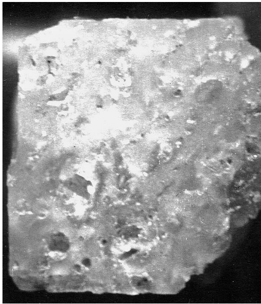
Рис. 37. А – поверхность спайного скола крупного кристалла переплавленной соли с кавернозной текстурой; Б – бета-радиография (пленка РТ-1) образца с кавернозной текстурой (темное – концентрация бета-излучающих радионуклидов). Увеличение 6,5 раз.
