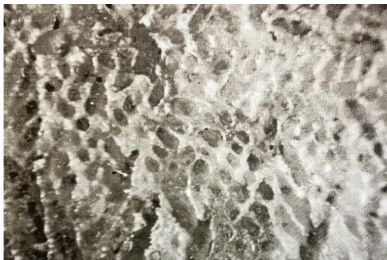
Рис.50. Ангидрит-галитовая порода с петельчатой структурой из нижней части донной линзы полости А-III. Увелич. 5 раз.
