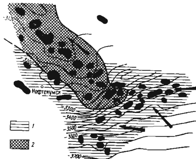
Рис. 12. Схематическая карта изменения величины отношения \Sigma ЦГ/ \Sigma ЦП в бензинах нефтей и конденсатах юрских пластов месторождений платформенной части Восточного Предкавказья.
