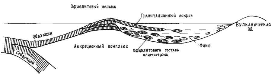
Рис. 25. Модель формирования олистостромы обдукционного типа.
