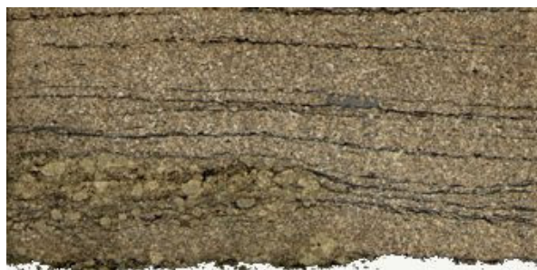
Рис. 6. Прослой конгломерата в отложениях усть-балыкской свиты Интервал 2220-2240 м
