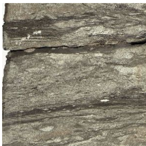
Рис. 10. Горизонтальная слоистость. Горизонтальные границы между слоями различного петрографического состава в породах сангопайской свиты Интервал 2045-2048 м
