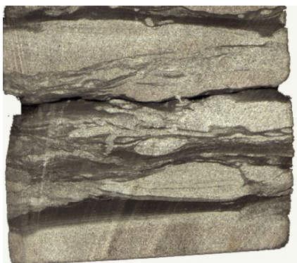
Рис. 3. Горизонтальная, линзовидно-прерывистая слоистость пород Сортымская свита. Интервал 2850-2855 м
