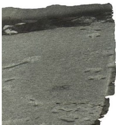
Рис. 8. Горизонтальная слоистость Аргиллит, серый раскалывающийся на мелкие плиточки параллельно слоисто- сти. Переходная зона между породами сортымской и усть-балыкской свитами Интервал 2240-2246 м
