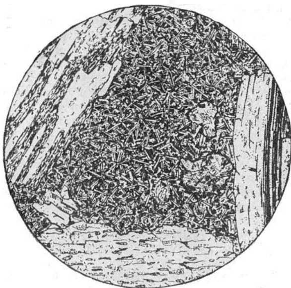
Рис. 3. Диабазовый порфирит. Порфировые выделения плагиоклаза в апоинтерсертальной основной массе, текстура миндалекаменная. Севернее г. Гурьевска. Шлиф, николи скрещены, d=5,7 мм
