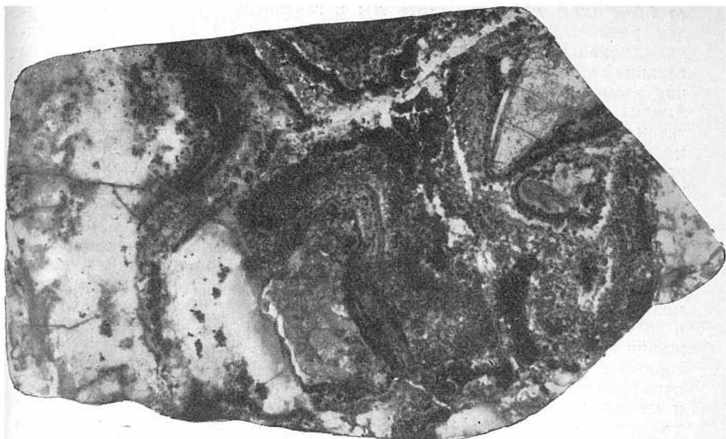
Рис. 5. Кокардовая текстура. Галенит, пирит и гематит (черное) располагаются тонкими концентрическими зернами вокруг обломков породы (серое); белое — кварц. Полиров. штупф, 1/2 натур. вел.
