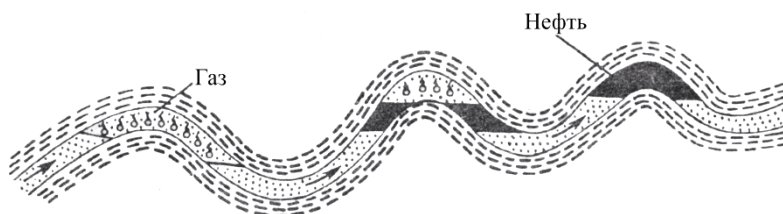
Рис. 31. Схема размещения залежей нефти и газа согласно принципу дифференциального улавливания углеводородов
