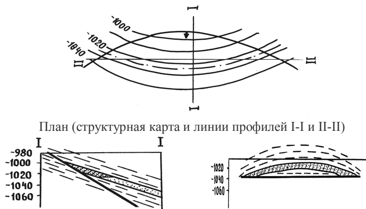
Рис. 10. Пластовая тектонически экранированная залежь в пределах моноклинали
