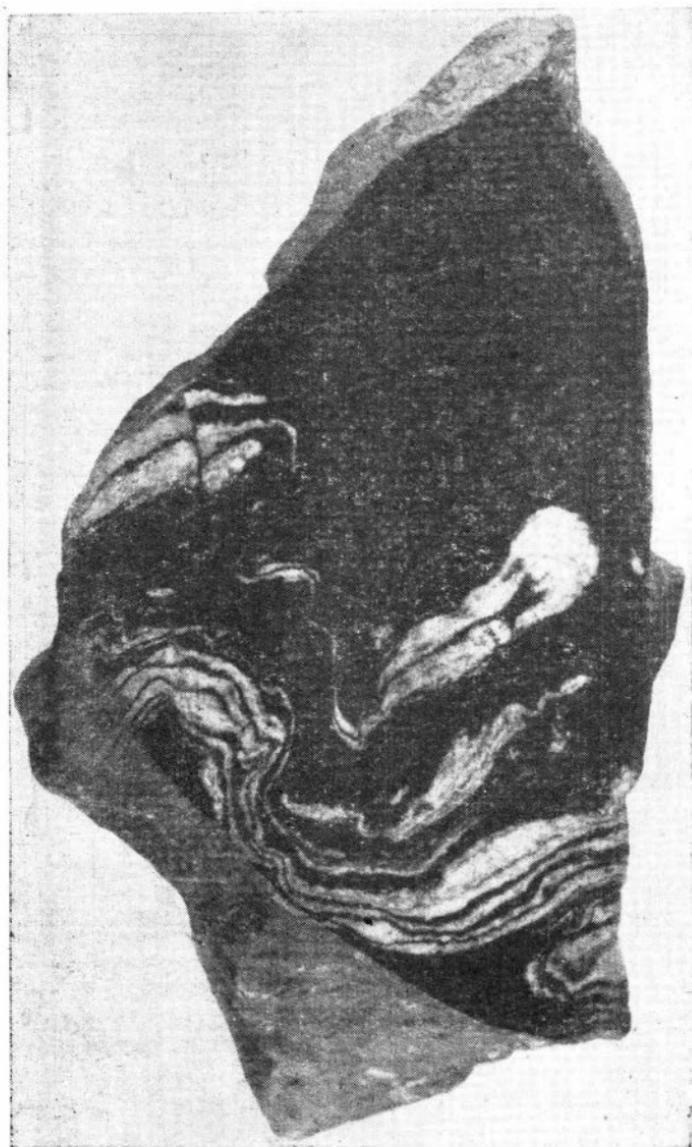
*Рис. 3.* Сложно деформированные обособления гранитного материала (белое) во вкрапленной кварц-роговообманково-магнетитовой руде. Штуф. Нат. вел.
