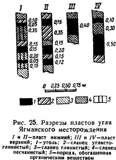
вами и наклонными шурфами по падению пластов. Однако все горные выработки, заложенные при разведке площади, не вышли из зоны тектонических нарушений и не дошли до угольных пластов. При разведке не были учтены особенности строения площади и не приняты во внимание послонные подвижки, что привело Е. А. Репман к отрицательным выводам при оценке угленосности площади. Площадь Шорли, так же как и Ягманская площадь, требует более детальной разведки путем проходки скважин глубиной 200—300 м.
