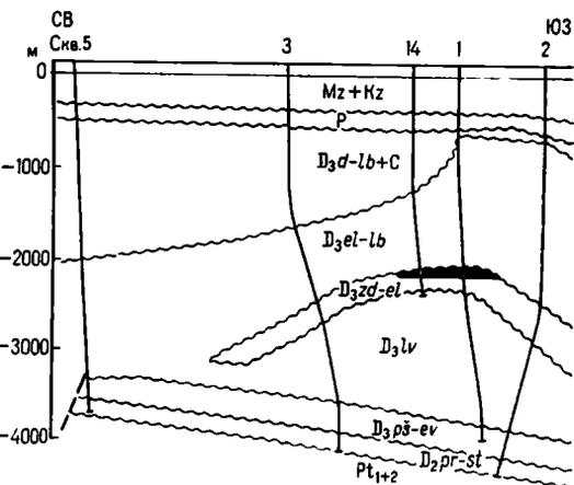
Рис. 14. Геологический профиль по линии скважин 5—2 Золотухинского нефтяного месторождения. Составил В. Н. Бескопильный.
