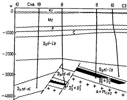
Рис. 13. Геологический профиль по линии скважин 19—10 Барсуковского нефтяного месторождения. Составили В. Н. Бескопыйный, В. Н. Макаревич.
