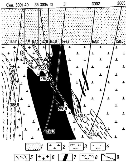
Рис. 35. Геологический разрез Долгиновского рудопроявления.
