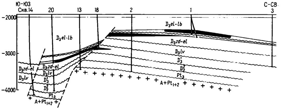
Рис. 7. Геологический профиль по линии скважин 14—3 Давыдовского нефтяного месторождения. Условные обозначения см. на рис. 1
