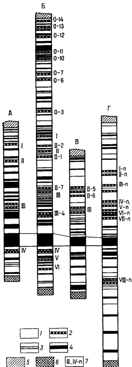
Рис. 41. Сопоставление сводных разрезов калиеносной подтолщи различных площадей западной части Припятской впадины. Составили Ю. И. Лупинович, В. З. Кисляк, Д. М. Ерошина, И. И. Зеленцов:
