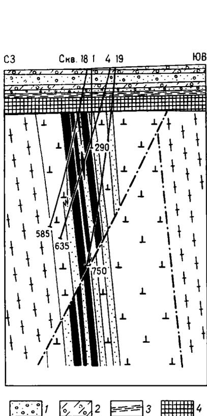
Рис. 33. Геологический разрез Новоселковского месторождения по линии I—I.
