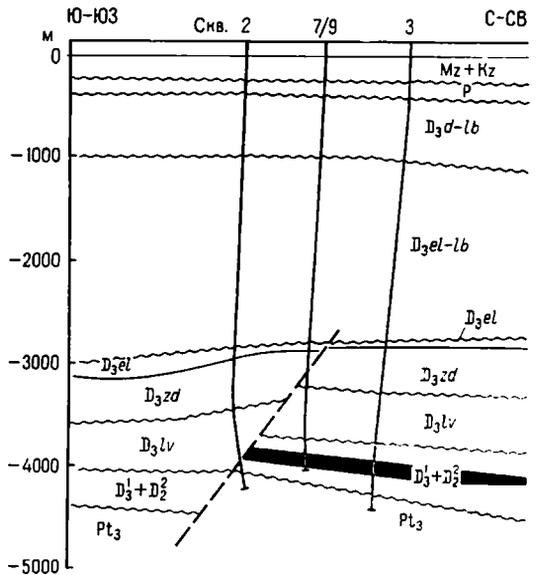
Рис. 16. Геологический профиль по линии скважин 2—3 Восточно-Первомайского нефтяного месторождения. Составили П. М. Зогуля, В. Н. Макаревич. Условные обозначения см. на рис. 1
