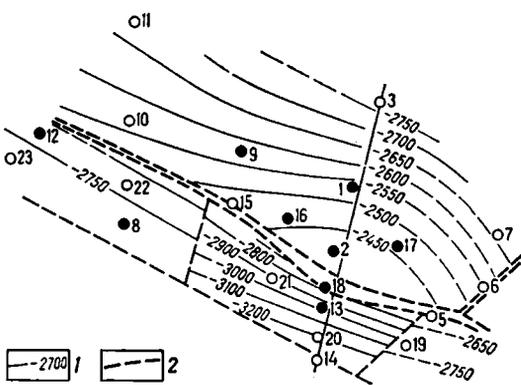
Рис. 8. Структурная карта по кровле задонского горизонта Давыдовского нефтяного месторождения. 1 — изогипсы кровли задонского горизонта; 2 — разрывные нарушения. Остальные условные обозначения см. на рис. 2
