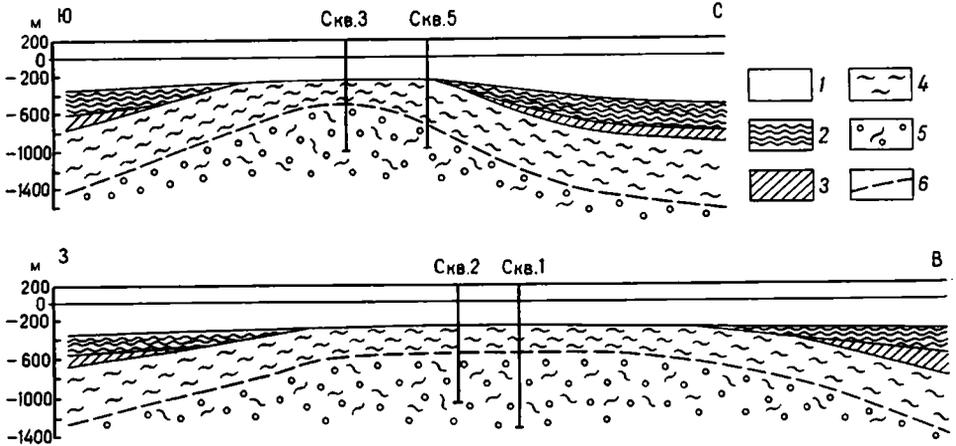
Рис. 42. Схематические геологические разрезы Мозырского месторождения каменной соли.
