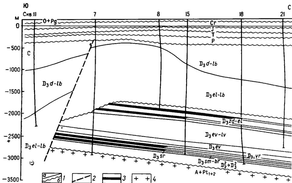
Рис. 1. Геологический профиль по линии скважин 11—21 Речицкого нефтяного месторождения. 1 — стратиграфические границы согласные (а) и несогласные (б); 2 — разрывные нарушения; 3 — залежи нефти; 4 — кристаллический фундамент
