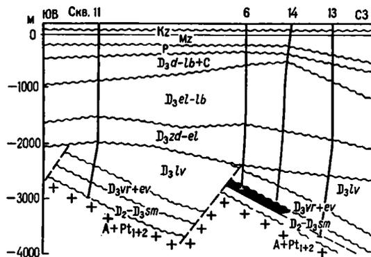
Рис. 12. Геологический профиль по линии скважин 11—13 Надвинского нефтяного месторождения. Составил В. Н. Бескопильный.
