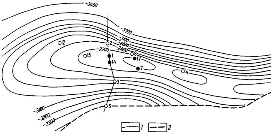
Рис. 15. Структурная карта по кровле межсоловых отложений Золотухинского нефтяного месторождения. Составил В. Н. Бескопыйный.
