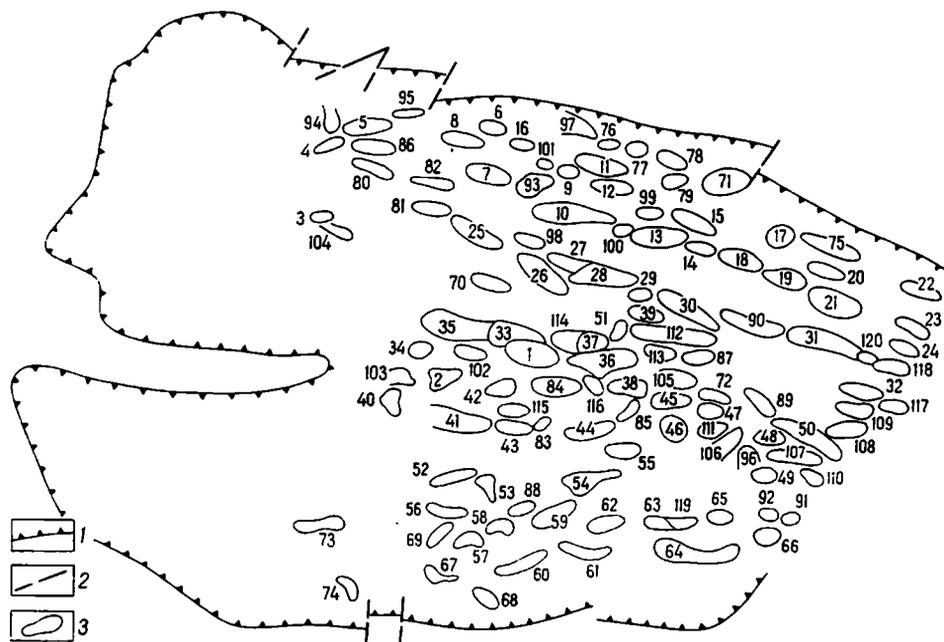
Рис. 22. Схема расположения локальных структур в Припятской впадине.
