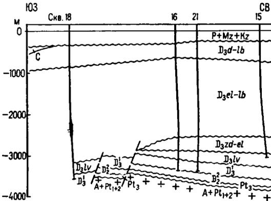
Рис. 20. Геологический профиль по линии скважин 18—15 Сосновского нефтяного месторождения. Составила Н. Ф. Травницкая.
