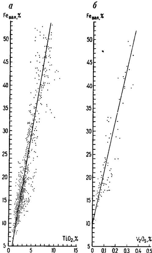
Рис. 34. Зависимость содержаний  $TiO_2$  (а) и  $V_2O_5$  (б) от содержания железа валового ( $Fe_{вал}$ ) в ильменит-магнетитовых рудах Новоселковского месторождения
