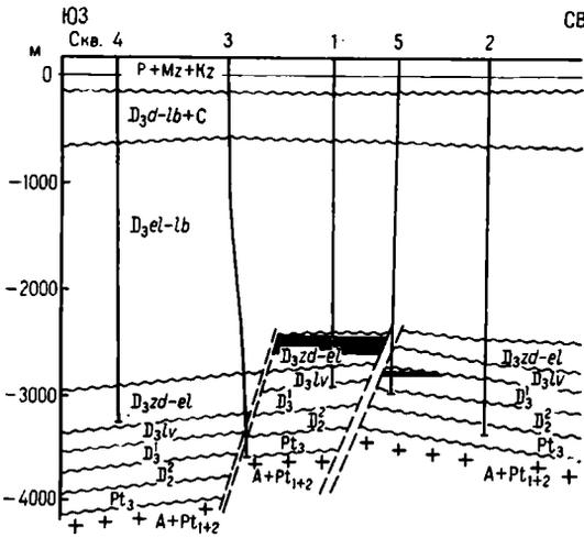
Рис. 18. Геологический профиль по линии скважин 4—2 Мармовичского нефтяного месторождения. Составила Н. Ф. Травницкая.
