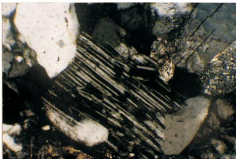
Рис. 32. Развальцевание и дробление со смещением обломков двойниковых индивидов в результате катаклаза. Новопокурское месторождение. Пласт Ю<sub>1</sub><sup>1</sup> Скв. 249, шл. 15631, 2830-2836 м, верх. С анализатором. (× 300).
