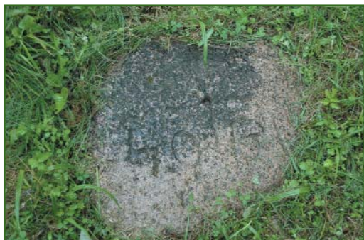
Рис. 6 Восстановленный в 1904 г. геодезический пункт с устойчивым центром
