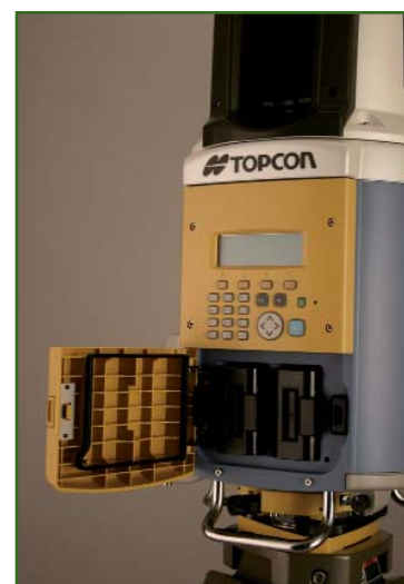
Рис. 5 Расположение аккумуляторов в сканере Topcon GLS-1000
