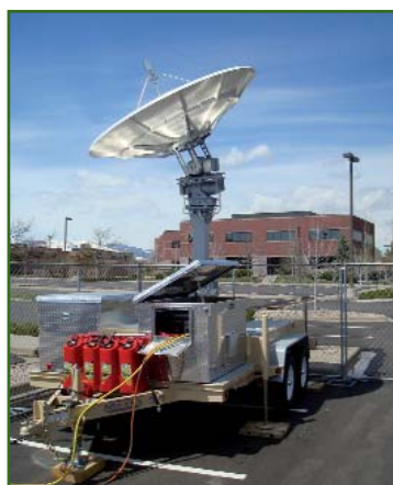
Рис. 1 Антенная система малогабаритного комплекса «УниСкан» в США
