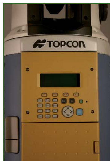
Рис. 2 Панель управления и дисплей сканера Торсон GLS-1000
