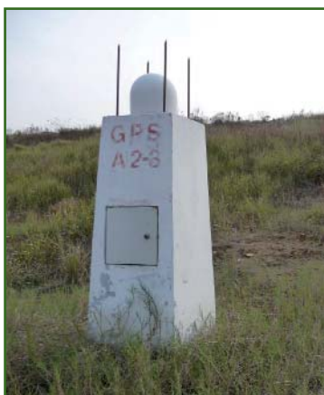
Рис. 4 Базовая станция сети Nanjing (Китай)
