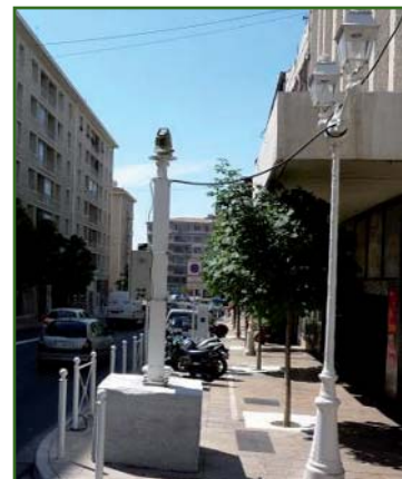
Рис. 8 Временный пилон с электронным тахеометром (Франция)
