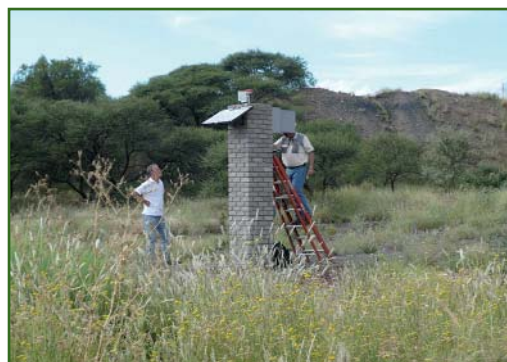
Рис. 3 Спутниковый приемник с антенной сети базовых станций De Beers (Австралия)
