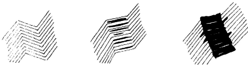
Рис. 10.8. Развитие кварцево-золоторудной минерализации в зоне кинкбанда по М. Уайвчару (Канада)
