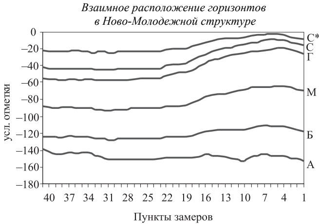
Рис.7.15. а – фрагмент временного разреза по Ново-Молодежной структуре, использованный для палеотектонических реконструкций; б – Относительное расположение основных отражающих горизонтов в условных абсолютных отметках, пропорциональных временной шкале глубин
