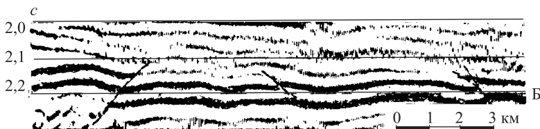
Рис. 7.9. Полого падающие разрывные нарушения (расчетный угол наклона сместителей от 10 до 25°)
